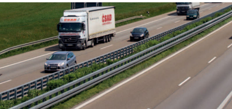
Bild 7: Super-Rail zweifach (H2/L2-W4-A und H4b/L4b-W7-A)
