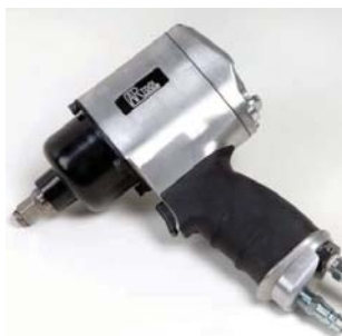
4.19 Festziehen der Schrauben mittels Schlagschrauber und anschließende Kontrolle mit Drehmomentschlüssel.
