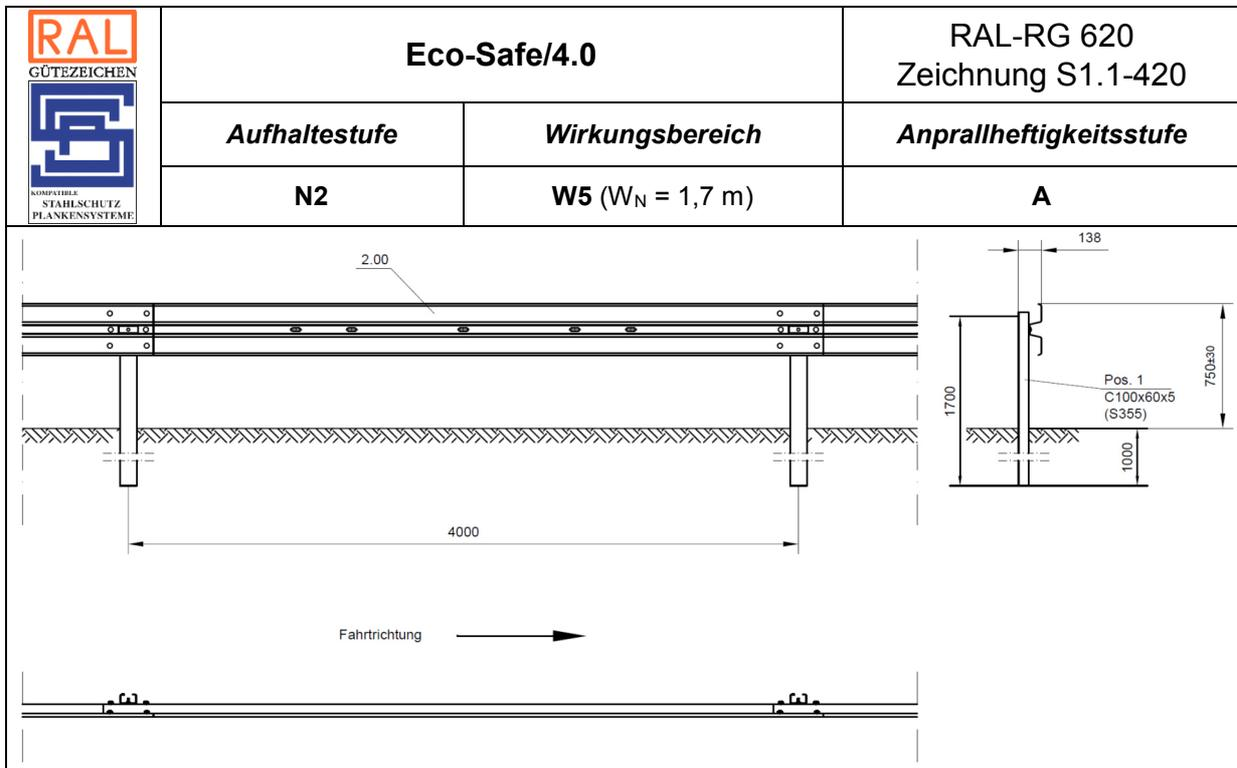
Die einseitige geramte Stahlschutteinrichtung besteht aus korrosionsgeschützt ausgeführten Bauteilen nach RAL-RG 620. Die Länge der Holme und Pfosten bestimmen das Format eines Elementes. Das System ist gekennzeichnet durch einen Pfostenabstand von 4,0 m und die an die Pfosten (Länge 1,70 m) angebrachten 4 m langen Holme. Die Schutzplankenholme überlappen und sind mit mehrfachen Schraubenverbindungen fixiert.
