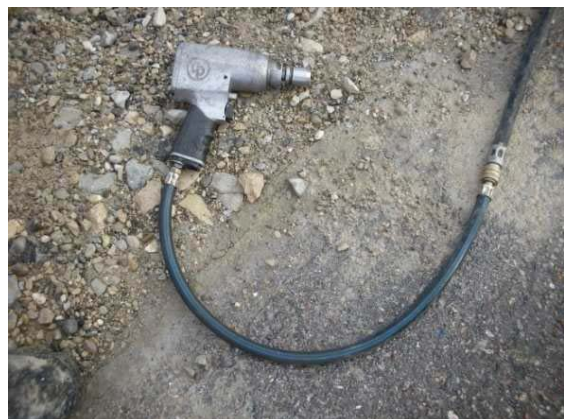
4.14 mit Schlagschrauber, überprüfen mit Drehmomentschlüssel
