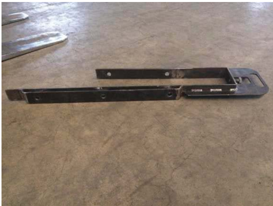
4.13 Bohrschablone für SSE Drilling-Template for NAE
