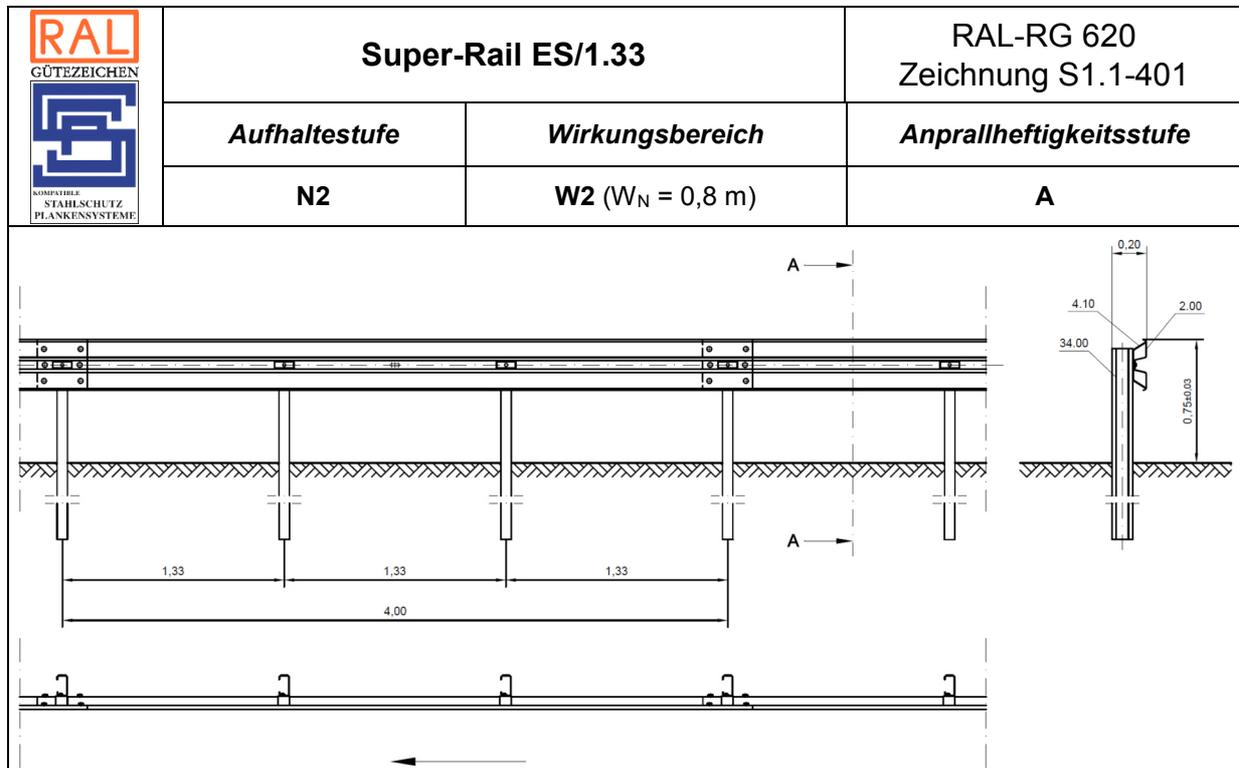
Die einseitige geramte Stahlschutzeinrichtung besteht aus korrosionsgeschützt ausgeführten Bauteilen nach RAL-RG 620. Die Länge der Holme und Pfosten bestimmen das Format eines Elementes. Das System ist gekennzeichnet durch einen Pfostenabstand von 1,33 m und die an die Pfosten (Länge 1,75 m) angebrachten 4 m langen Holme. Die Schutzplankenholme überlappen und sind mit mehrfachen Schraubenverbindungen fixiert.
