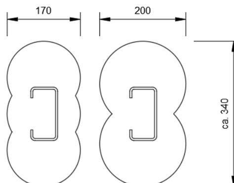
Das Bohrloch muss mit Sand, Kies, unbelastetem Bohrgut oder ähnlichem Material verfüllt werden.
