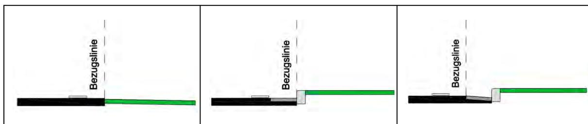
Sofern ausreichend Platz vorhanden ist, sollte bei Borden die Schutzeinrichtung hinter der Rückenstütze gerammt werden. Eine Beschädigung der Bordanlage kann ansonsten nicht ausgeschlossen werden.
