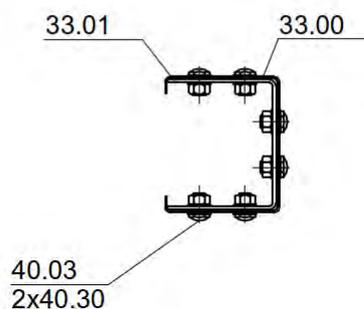
Verschraubung Kastenprofil mit Pfosten
