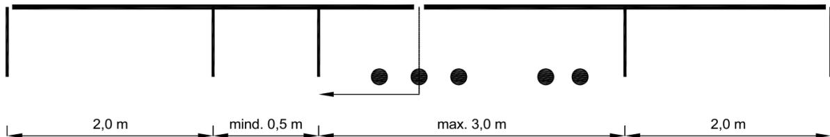
Werden Pfosten verschoben oder Zusatzpfosten gerammt, dass ist darauf zu achten, dass diese Pfosten nicht in den Stoßbereich des Kastenprofils gesetzt werden dürfen. Der Abstand zum Kastenprofilstoß muss so groß sein, sodass Befestigungswinkel und Stoßverbinder sich nicht überlappen.
