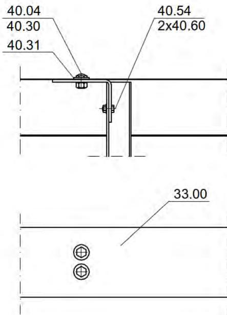
Verschraubung Defobügel mit Pfosten und Holm
