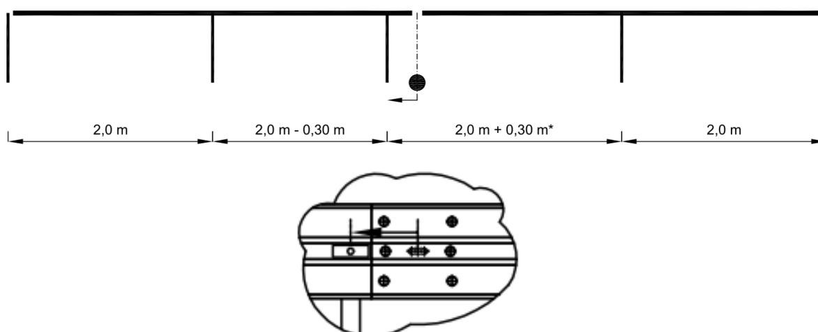
Kann ein Pfosten auch unter Ausnutzung der Toleranz von  $+ 30$  cm nicht an der vorgesehenen Stelle eingerammt werden, muss der Pfosten entsprechend verschoben und ein zusätzlicher Pfosten gerammt werden. Der Abstand zwischen dem verschobenen Pfosten und dem Zwischenpfosten darf maximal  $2,0\text{ m} + 0,30$  m betragen.
