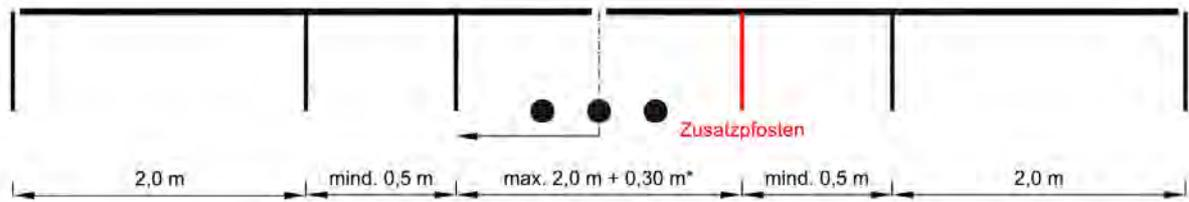
Ist der Schutzstreifen für die Kabeltrasse oder der Schacht so breit, dass der Abstand zu den angrenzenden Pfosten 0,50 m unterschreitet, kann ausnahmsweise der Zusatzpfosten weggelassen werden. Dies darf jedoch nur bis zu einem maximalen Pfostenabstand von 3,00 m ausgeführt werden. Zuvor muss jedoch geprüft werden, ob eine regelkonforme Lösung oder ein verbessertes Schutzniveau möglich ist, wenn der angrenzende Pfosten ebenfalls verschoben wird.
