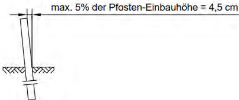
An Straßen mit sehr großem Längsgefälle, kann es vorkommen, dass der Winkel zwischen den Längselementen und den Pfosten zu stark von einem  $90^\circ$ -Winkel abweicht, sodass eine Montage nicht mehr möglich ist. In diesen Fällen können Pfosten in Längsrichtung konstruktionsbedingt abweichend von der lotrechten Montage gerammt werden. Eine senkrechte Ausrichtung ist dann zu empfehlen.
