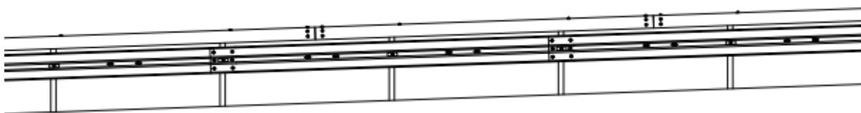
Pfosten senkrecht zur Fahrbahn gerammt, wenn bei starkem Längsgefälle eine Montage konstruktiv bedingt mit lotrechten Pfosten nicht möglich ist.
