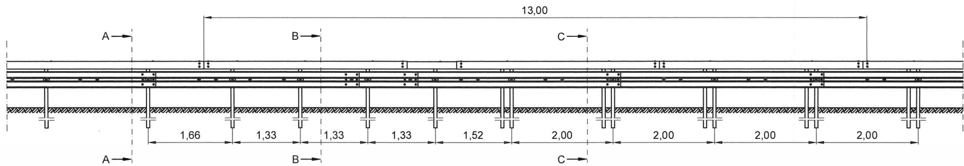
Die Ausführung ist abhängig von der Orientierung des C-125 Pfostens .
