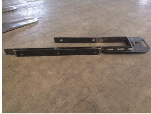
4.13 Bohrschablone für SSE Drilling template for NAE
