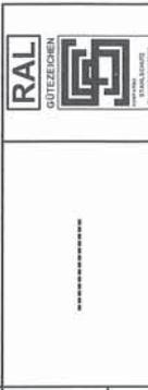
Die Kennzeichnungen müssen im montierten Zustand stets einmal und dauerhaft sichtbar sein.
